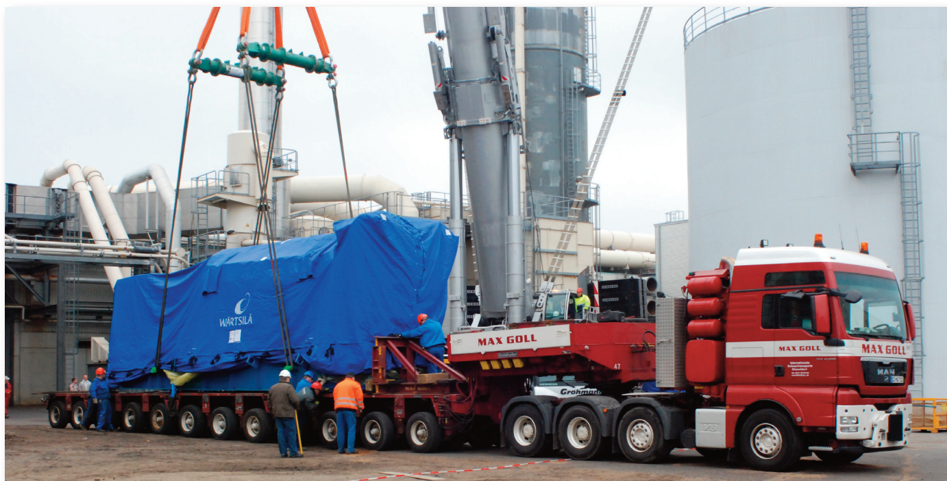
Verladung eines Motors auf einen „12-Achs-Roller“: Das Gesamtgewicht dieser Kombination betrug knapp 170 to.
